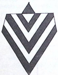
8. Arraia de costelas. Cobertura caprichada. Também pode ser de várias cores ou bicolor. Geralmente o soldador a faz para seu prazer e ostentação.
